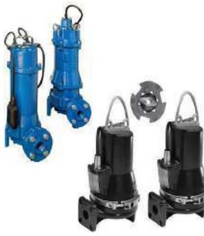
Pompes submersibles dilacératrices avec broyeur fiables et polyvalentes pour le relevage des eaux non traitées. La pompe broyeur est conçue pour assurer un broyage efficace et fiable, éliminant quasiment le risque de colmatage ou de blocage.
