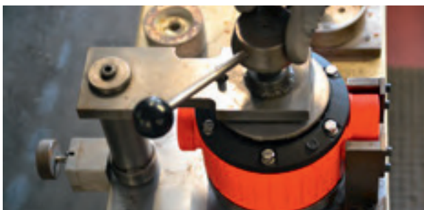
Les compteurs de débit FMC/FMJ sont complètement montés chez FLUX avec des dispositifs de montage spécifiques, également fabriqués sur site.
